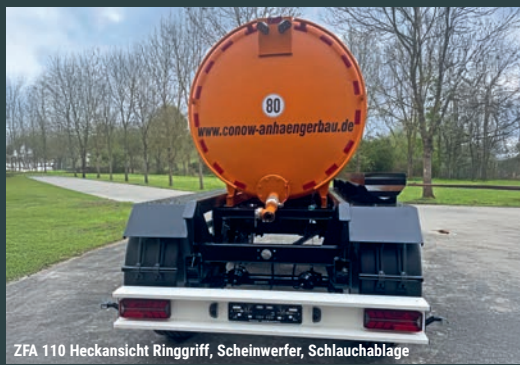
ZFA 110 Heckansicht Ringgriff, Scheinwerfer, Schlauchablage
