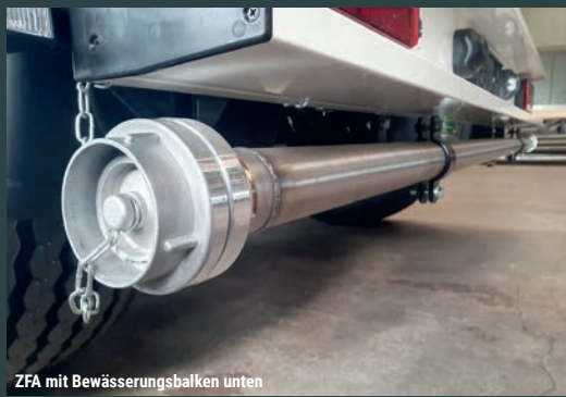
ZFA mit Bewässerungsbalken unten
