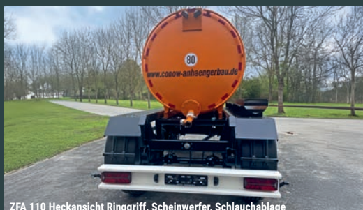
ZFA 110 Heckansicht Ringgriff, Scheinwerfer, Schlauchablage
