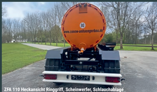
ZFA 110 Heckansicht Ringgriff, Scheinwerfer, Schlauchablage
