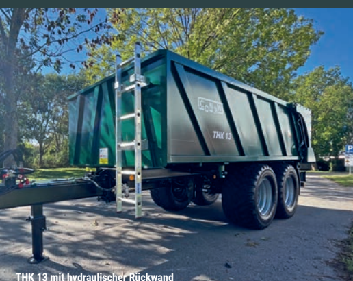
THK 13 mit hydraulischer Rückwand
