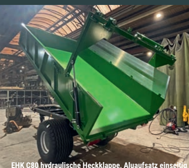
EHK C80 hydraulische Heckklappe, Aluaufsatz einseitig
