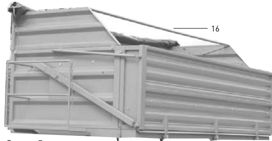
System 5 Laderaumabdeckung bei aufgebautem Überblaseschutz (Variante: 3.2, 3.2.1, 3.3, 4.2, 4.2.1, jeweils mit ÜBS) bestehend aus: Rollplane mit Alu-Schiene, seitlich umlegbarem Mittelrohr, Planenzubehör
