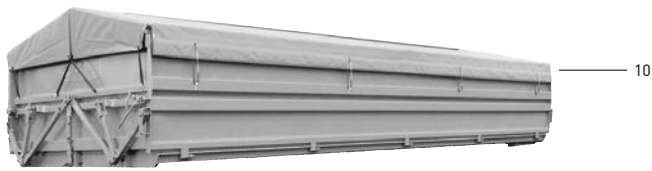
System 1 Laderaumabdeckung für Aufbauten mit herkömmlicher Kinematik (Variante 1) bestehend aus: Mühlendreieck vorn, Mühlendreieck hinten, Mittelteil, Gestänge, seitlich umlegbarem Mittelrohr, Rollplane, Alu-Schiene mit Kurbel, Befestigungsgummis zur Selbstmontage
