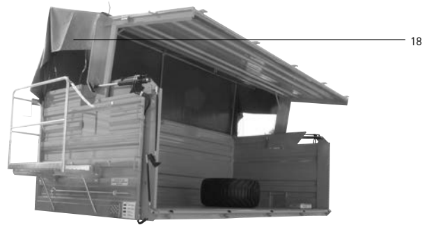
System 4A Laderaumabdeckung für ganzflächige Bordwandöffnungen Variante 9 bestehend aus: einem dreiteiligen klappbaren Spiegelgestell, mit seitlich umlegbarem Mittelrohr, Gestänge, Rollplane, Alu-Schiene mit Kurbel, Befestigungsgummis zur Selbstmontage
